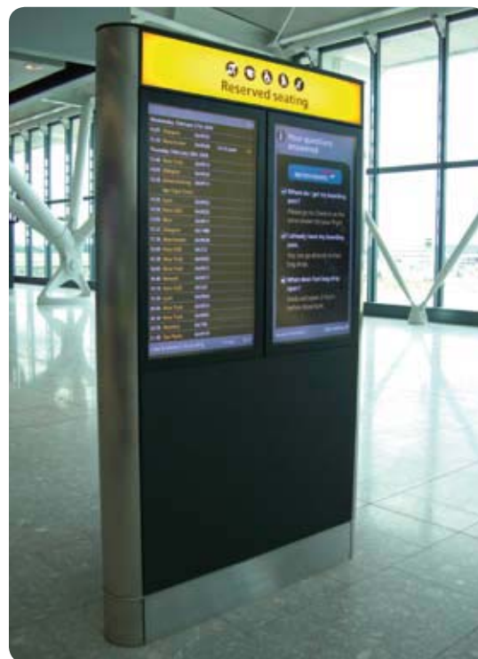
PCP mit entspiegelter Polycarbonat-Scheibe aufgestellt in Heathrow T5
